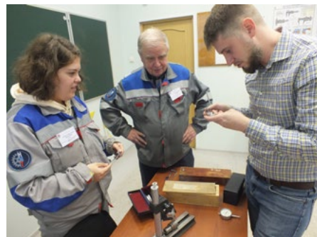
Е.С. Юрасова, А.Г. Бурина и С.И. Васильев собирают индикаторную стойку для проверки размеров тел вращения
